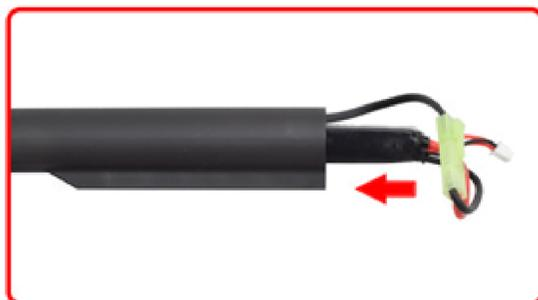
5- Inserisci la batteria ed il cavo al interno del tubo calcio.
